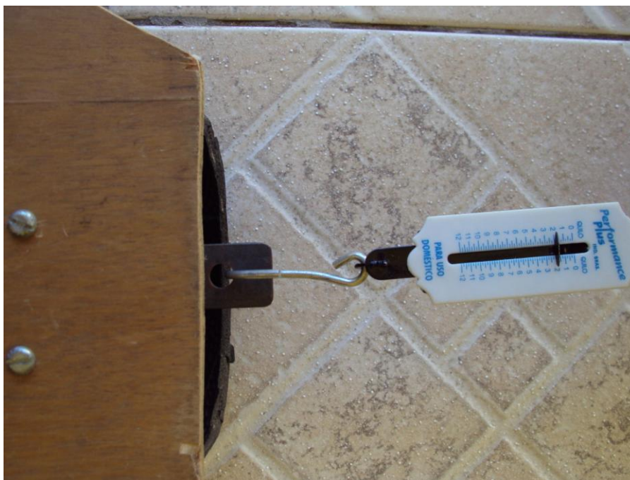
Figura 3: Obtenção da medida da força de atrito cinético, com o objeto deslizando com velocidade constante em relação à superfície.
