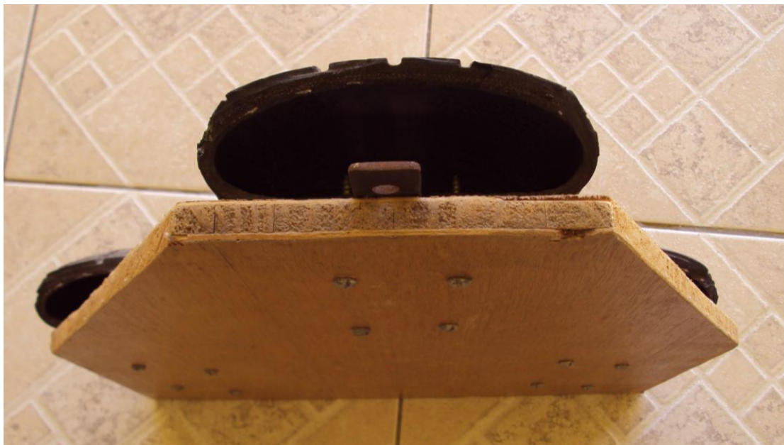
Figura 6: Vista do aparato, mostrando o gancho e os parafusos prendendo os pneus.
