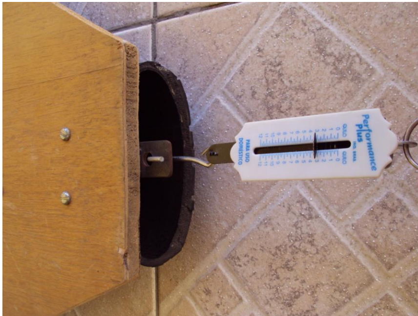
Figura 2: Obtenção da medida da força de atrito estático máxima, na iminência de derrapagem.
