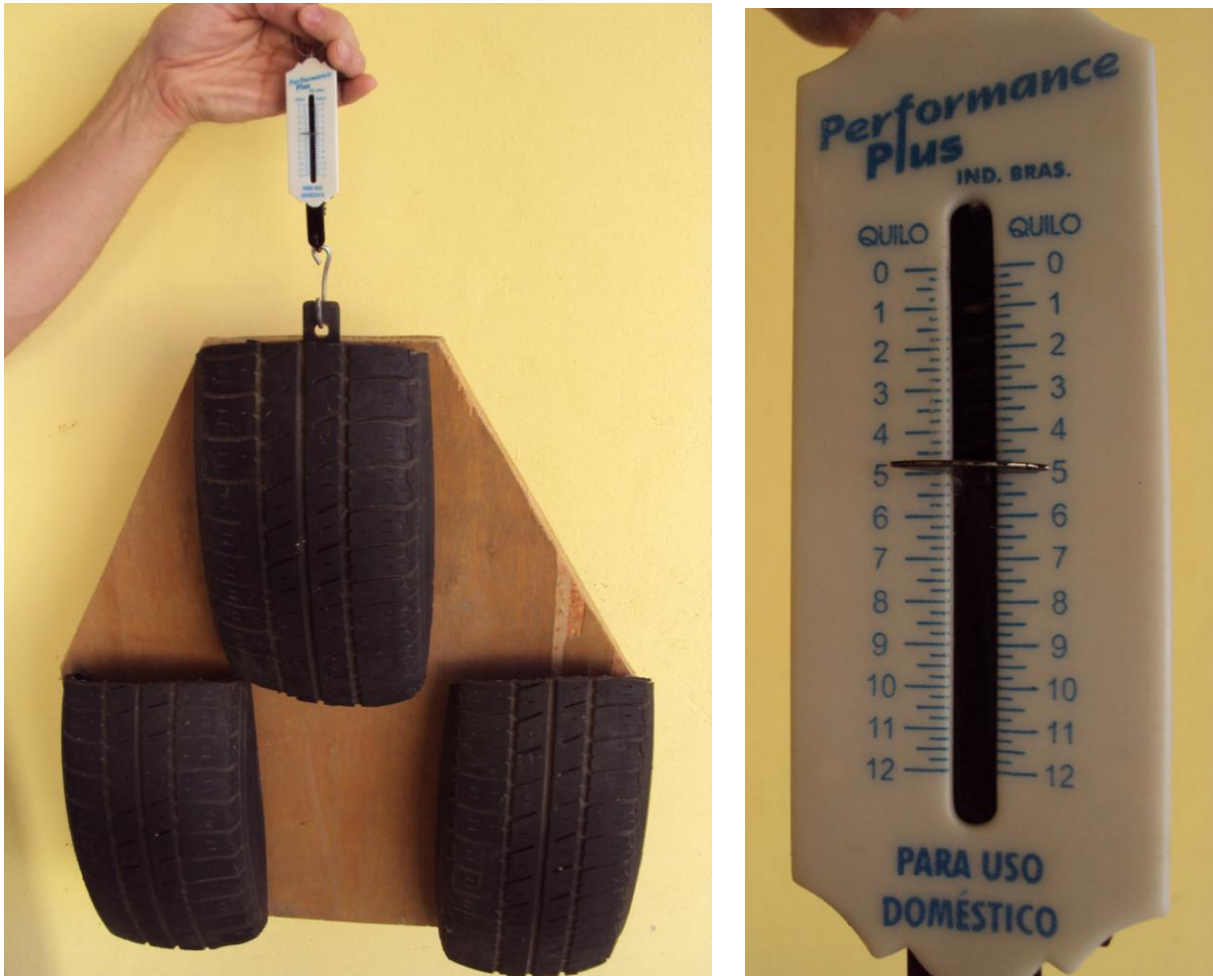
Figura 4: Obtenção da medida da força peso sobre a tábua com os pneus, com o objeto pendurado verticalmente.
