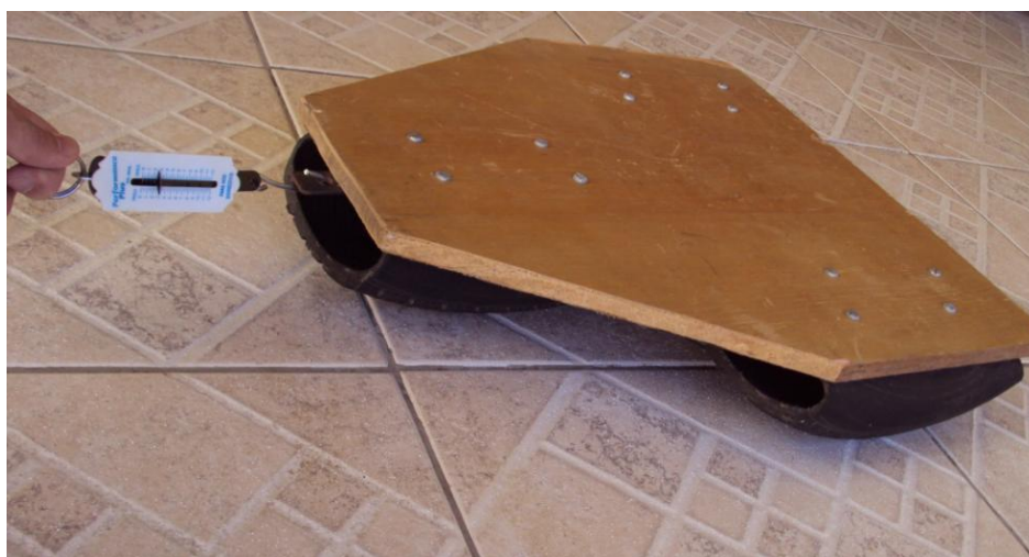
Figura 1: Tábua com pedaços de pneus sendo puxada sobre uma superfície horizontal para se obter as medidas da força de atrito.
