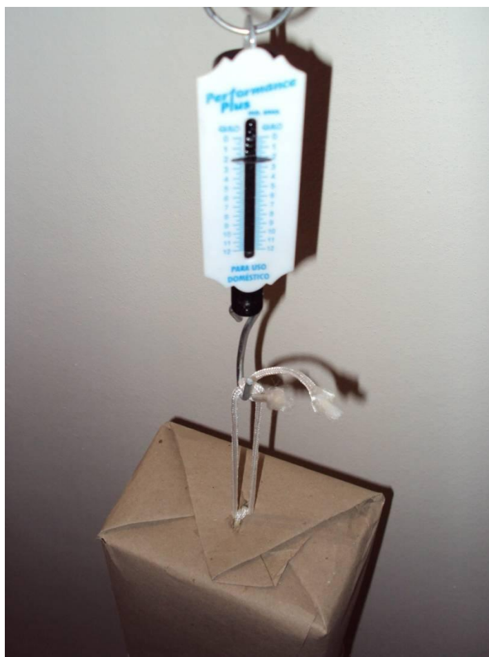
Figura 2: Bloco pendurado verticalmente para determinação da intensidade da força peso sobre o bloco.
