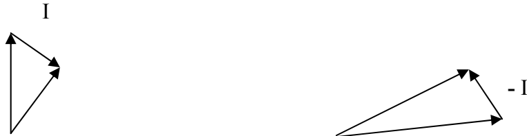
Figura 3.4.6.1. Representação do impulso resultante, proveniente da figura 3.4.3.1 em coordenadas x,y (Dinâmica dos acidentes de trânsito: Análises e reconstruções, 2003, pág. 19).
